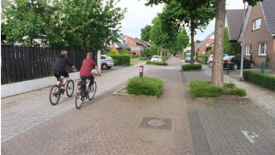
Abbildung 17: Oberflächenstruktur und die Anordnung der begrünten Inseln — u.a. in der Fahrbahnmittle — reduzieren die Geschwindigkeiten in diesem verkehrsberuhigten Bereich (VZ 325) spürbar.
