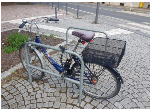
Abbildung 89: Anlehnbügel mit Querholm, Ausführung Rundrohr (links), Abstände von Anlehnbügel bei Doppelaufstellung (rechts)
