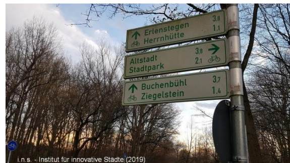
Abbildung 67: Bei der Verwendung von Pfeilwegweisern (links) werden alle Fahrtrichtungen an einem Standort ausgewiesen, was die Erkennbarkeit deutlich reduziert. Besser geeignet sind Tabellenwegweiser, die bereits vor dem Knotenpunkt stehen und auch während der Fahrt gut erfasst werden können (rechts).
